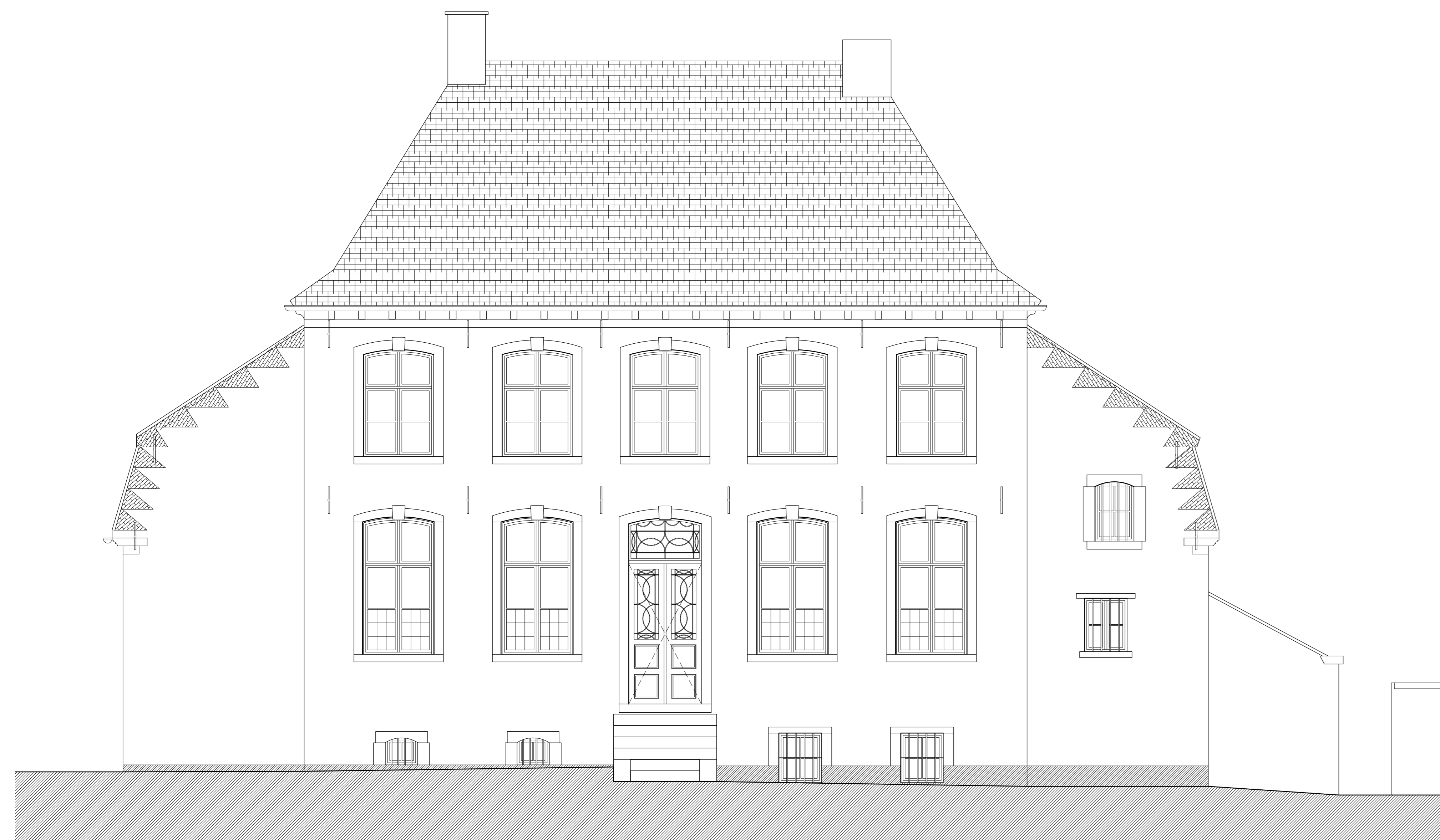
ACHTERGEVEL BESTAANDE TOESTAND schaal 1:50
